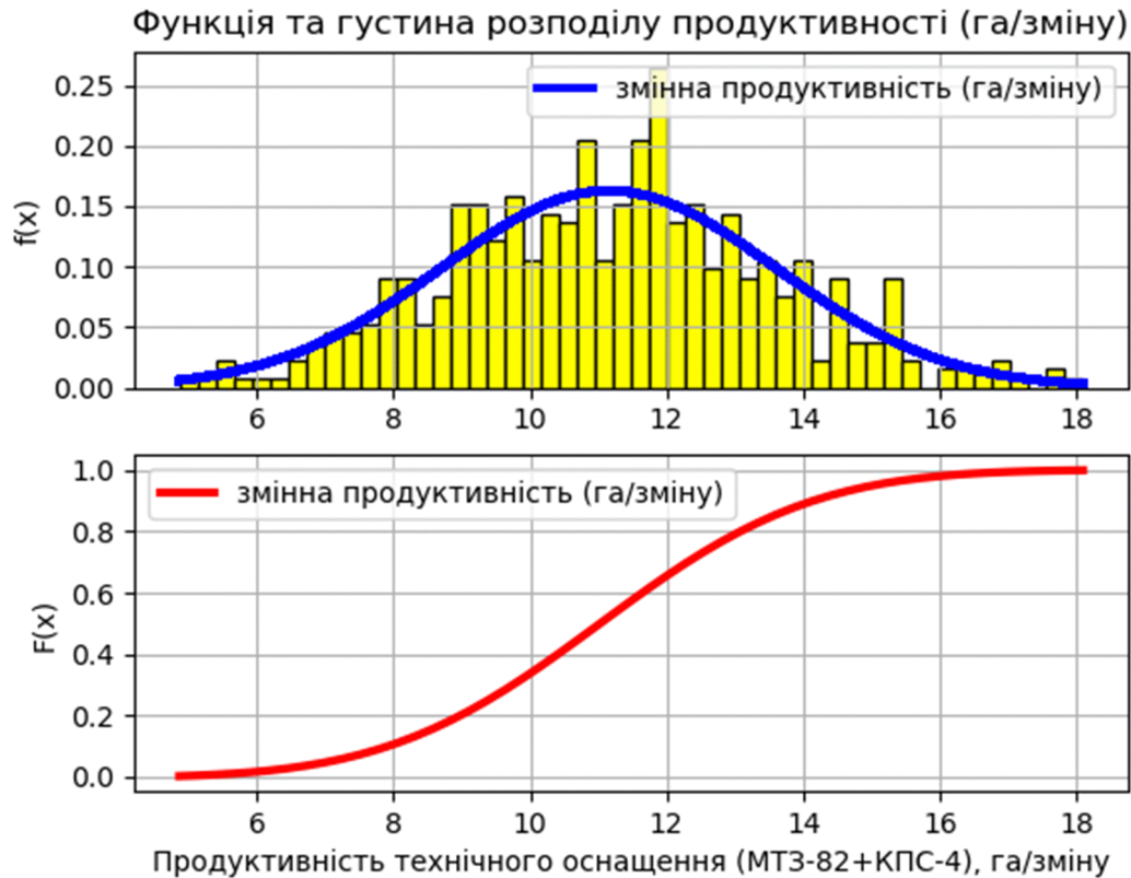
Рис. 5.5. Густина та функція розподілу по продуктивності техніки (агрегат МТЗ-82+КПС-4), га/зміну.
