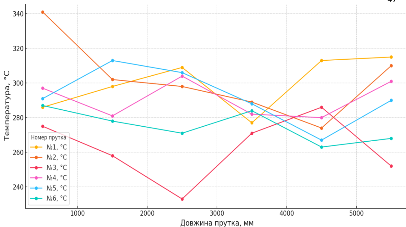
Рисунок 3.9 - Коливання температури по довжині прутків термонапруженої арматури Ø 14 мм зі сталі 25Г2С за час нагріву 90с.
