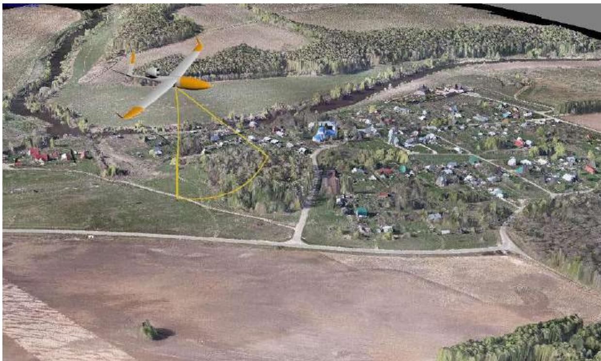
Рис 3.4. Виконання знімання за допомогою безпілотного літального апарату
