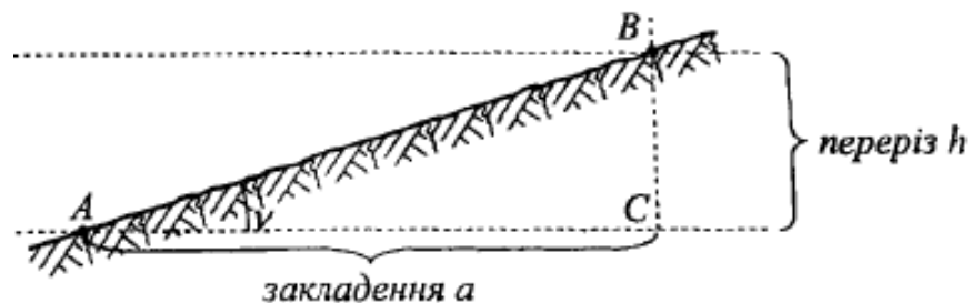
Рис. 1.3 До пояснення обґрунтування вибору перерізу рельєфу.
