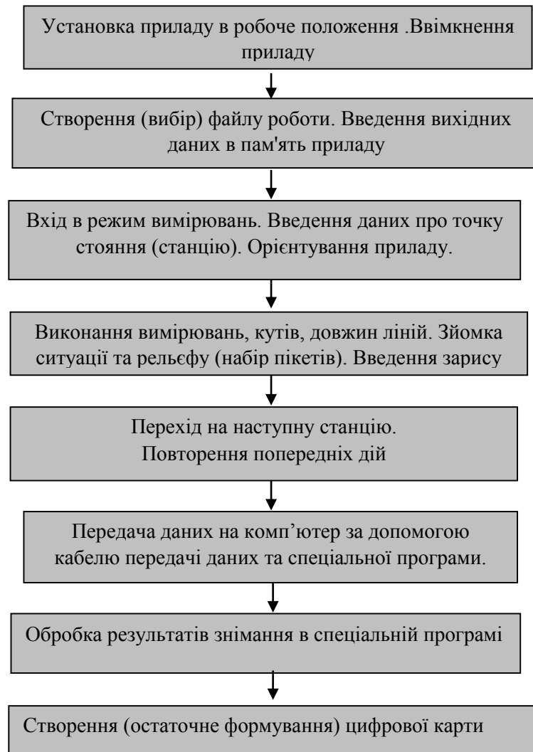
Рис. 3.1. Технологічна схема створення цифрових карт з використанням електронних тахеометрів та спеціального комп'ютерного забезпечення
