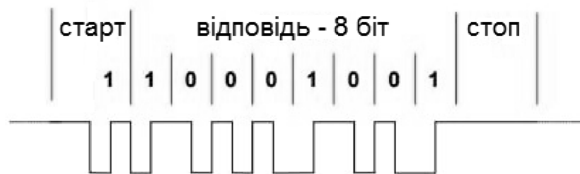
Рисунок 2.5 – Структура відповіді кінцевого пристрою в мережі DALI
