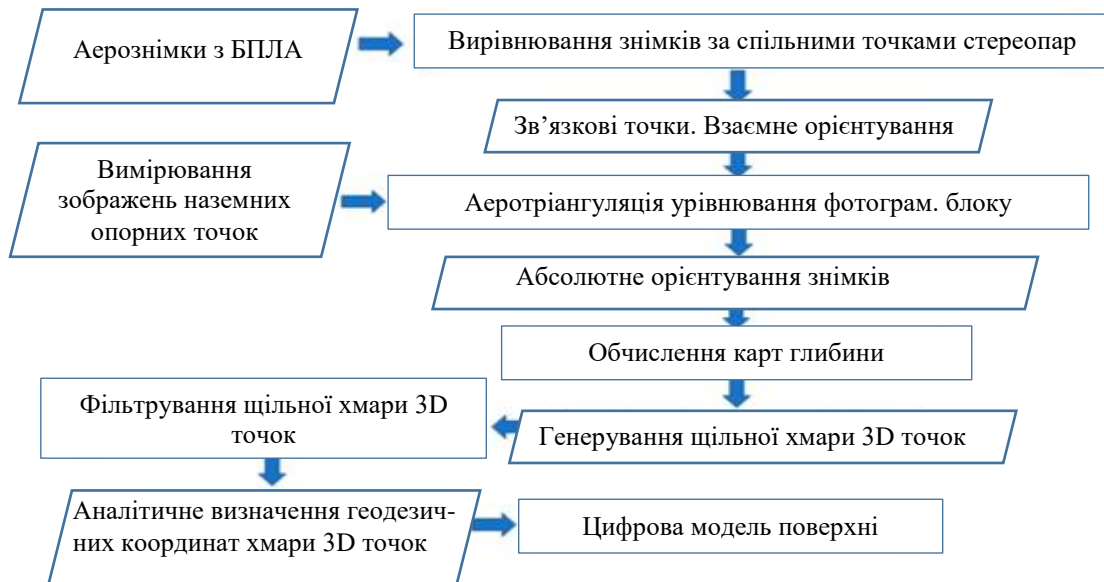
Рис.1.7. Схема фотограмметричного опрацювання матеріалів аерознімання
