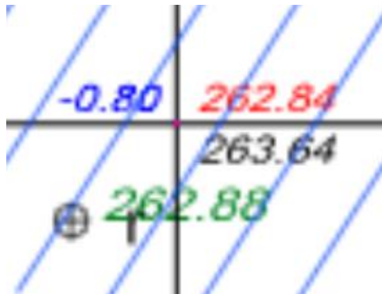
Рис.3.11. Приклад оформлення окремого вузла картограми земляних робіт
