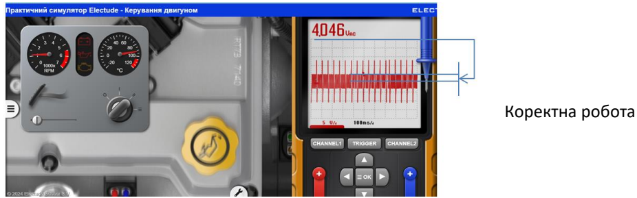
Рисунок 3.8 – Результати дослідження індуктивного датчика у віртуальному середовищі «Electude»
