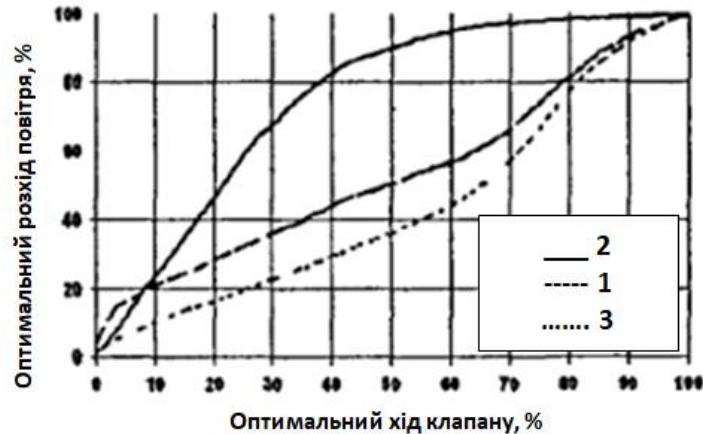
Рисунок 1.3 – Графіки оптимального розходу повітря через байпасний отвір за режимів: запуску, прогрівання та за встановленої робочої температури.
