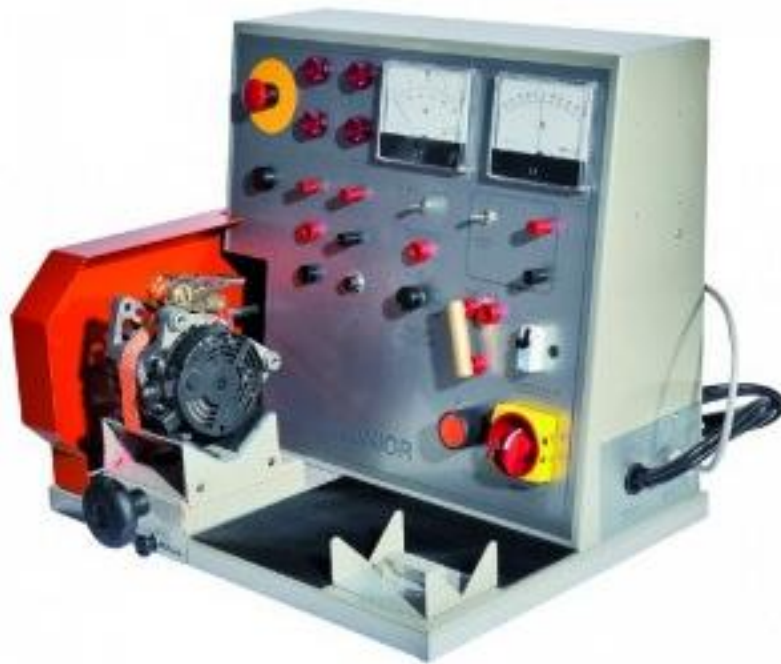
Рисунок 2.3 – Стенд SPIN Banchetto JUNIOR для перевірки генераторів і стартерів 380 В
