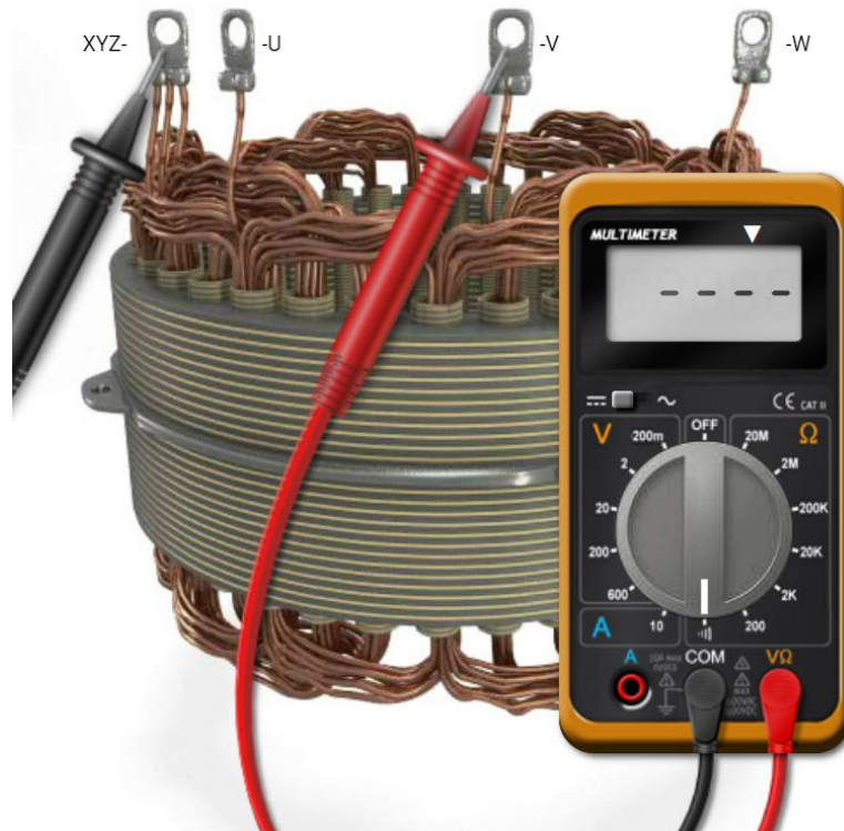
Рисунок 2.1 – Спосіб діагностування статора стартера.
