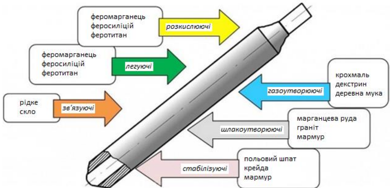
Рисунок 1.5 – Компоненти покриття електродів для РДЗ
