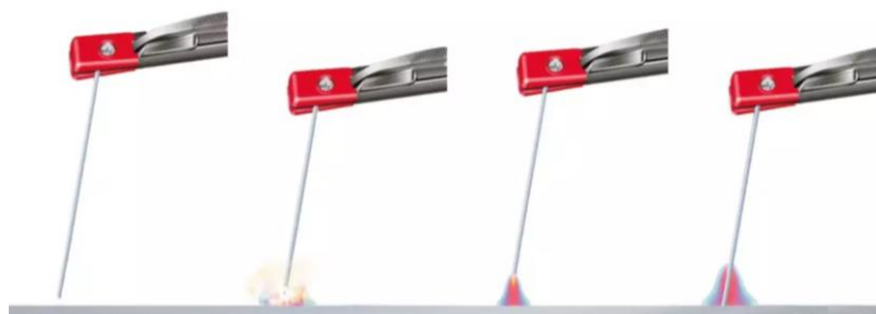
Рисунок 1.2 – Процес утворення зварювальної дуги
