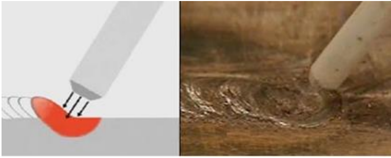
Рисунок 2.4 - Положення електрода під час зварювання
