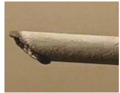
Рисунок 2.5 - Розплавлення електрода при його значному нахилі
