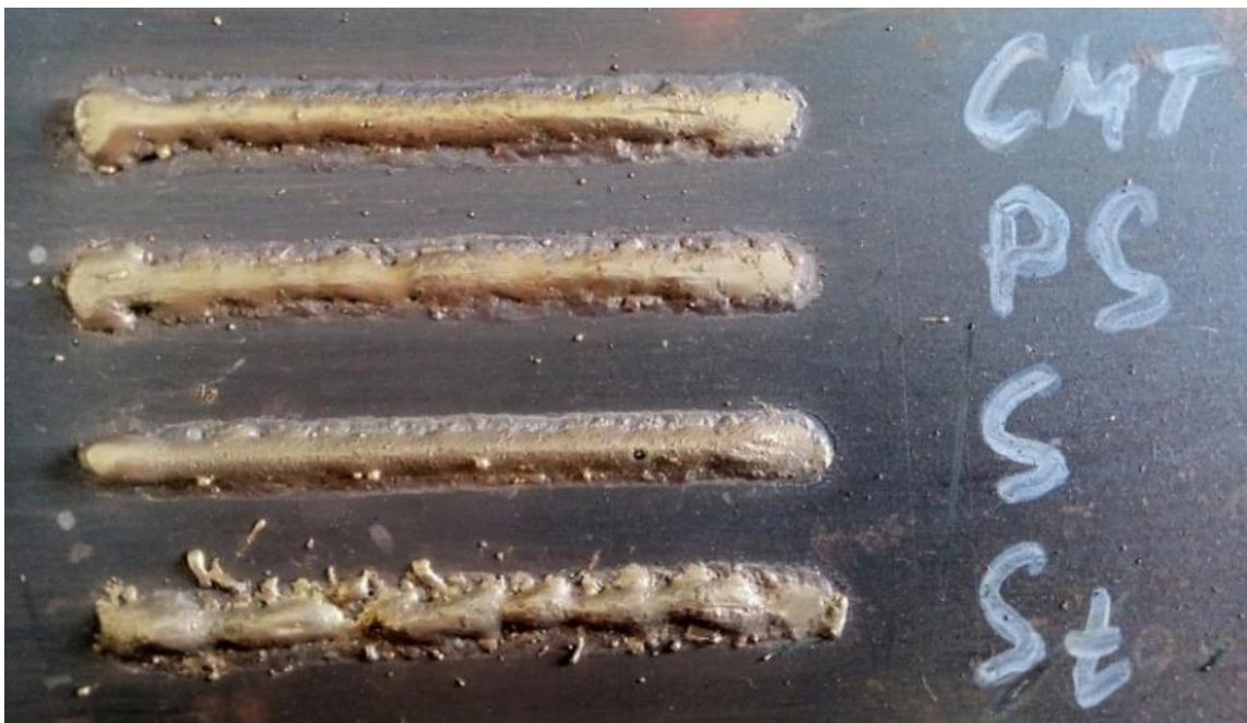
Рисунок 3.3 - Наплавлені валики методом MIG-паяння в режимах: CMT – Cold Metal Transfer; PS – Pulse Synergic; S – Synergic; St – Standard
