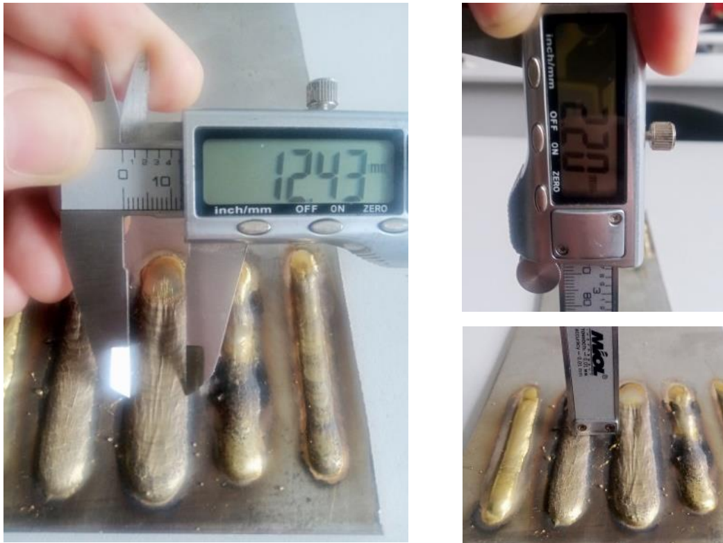
Рисунок 3.4 - Вимірювання розмірів зварного шва
