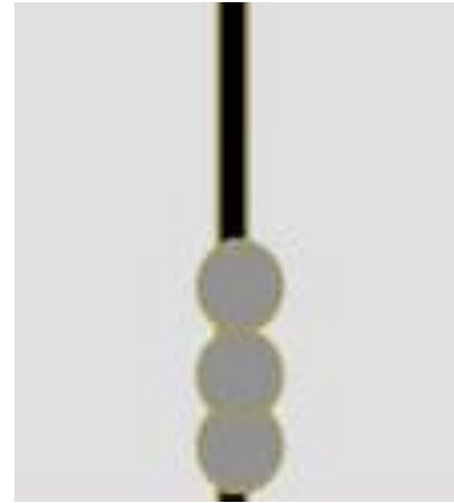
Рисунок 1.2 – Схема розташування точок під час MIG-пайки пластин стиковим швом
