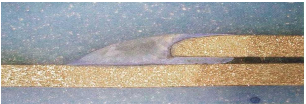
Рисунок 1.3 – Макро-фото стикового шва, виконаного методом MIG-пайки
