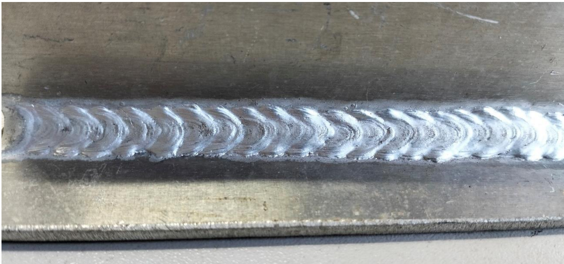
Рисунок 3.11 – Вплив частоти змінного струму на форму зварних швів
