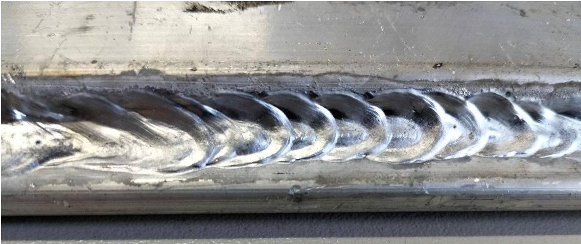
Рисунок 3.10 – Вплив зміщення змінного струму на процес зварювання
