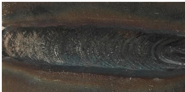
Рисунок 3.4 – Результати виконання стикових зварних швів нержавіючої сталі на різних режимах імпульсного зварювання
