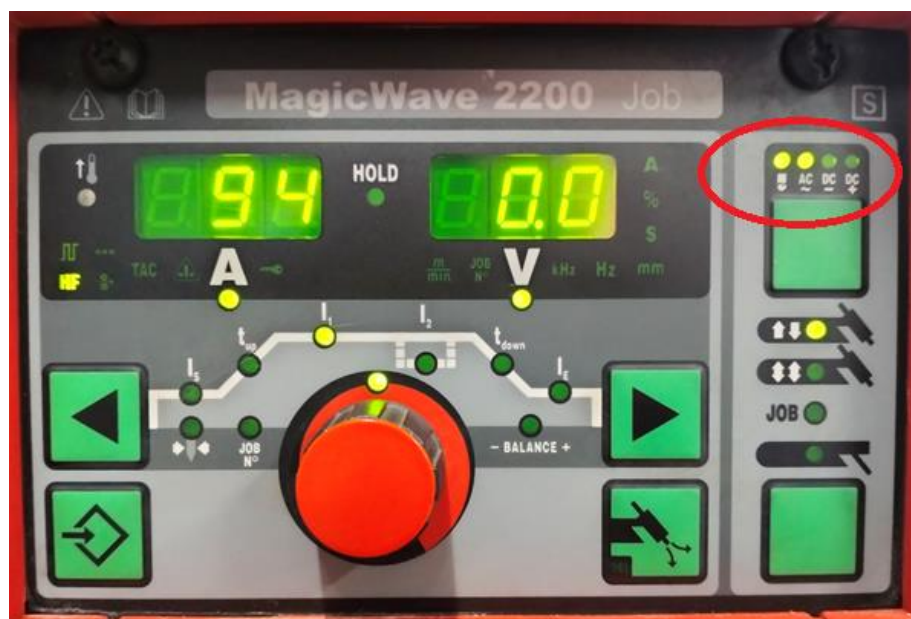
Рисунок 3.13 – Увімкнення функції автоматичного утворення кульки на кінці електрода
