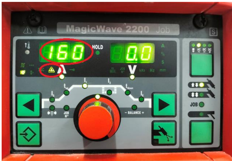
Рисунок 3.16 – Сигнал індикатора про перевантаження електрода та максимально дозволений струм зварювання
