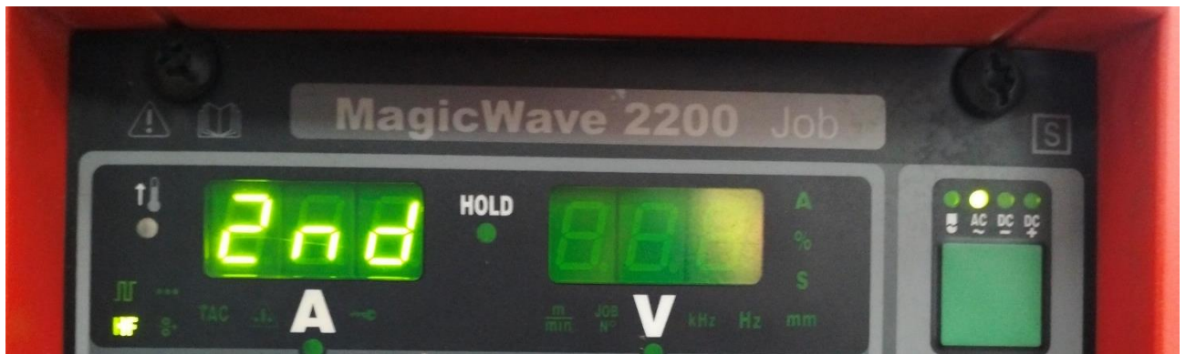
Рисунок 3.6 – Відновлення заводських налаштувань (а) та перехід на другий рівень налаштувань (б)
