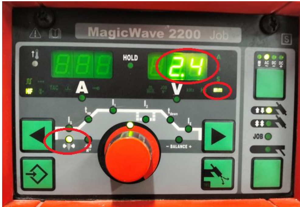
Рисунок 3.15 – Встановлення діаметра електрода
