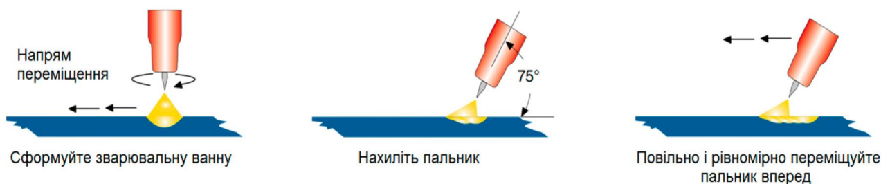
Рисунок 1.10 – Ведення процесу зварювання без присадки
