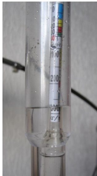
Рисунок 5.4 – Щільність електроліту в кінці процесу заряду
