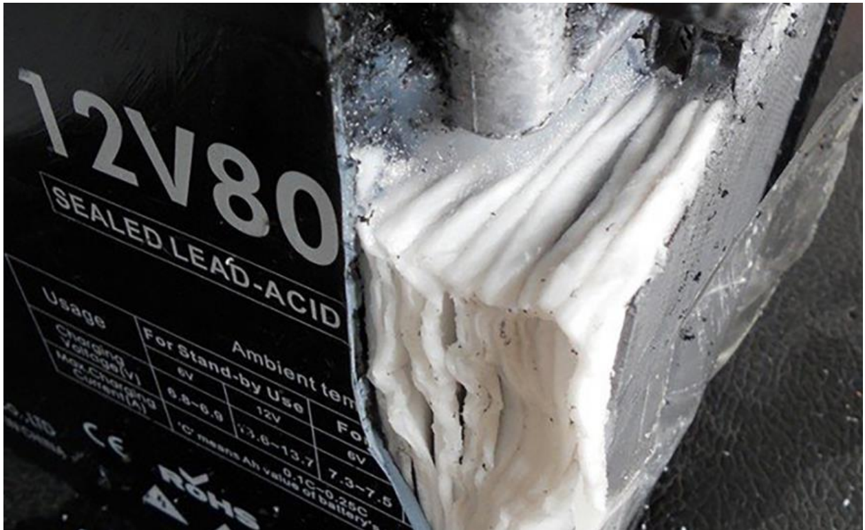
Рисунок 1.3 – Гелевий акумулятор в розрізі
