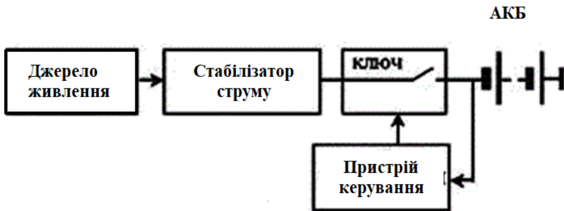
Рисунок 2.3 – Схема заряду акумулятора при постійній силі струму
