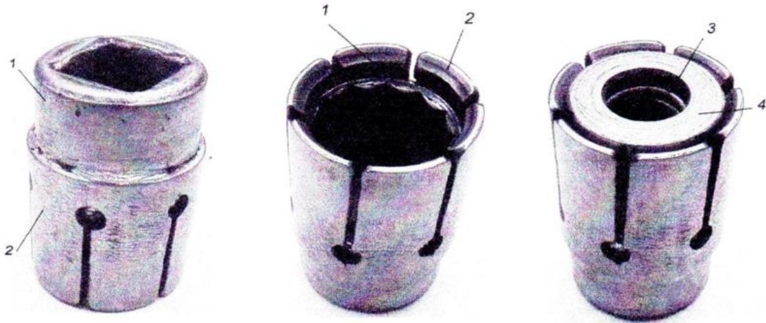
Рисунок 3.3 – Головка для захоплення гайки з шайбою із касети: 1 - стандартна головка; 2 - цанговий тримач шайби; 3 - гайка М14х1,5; 4 - шайба 14.
