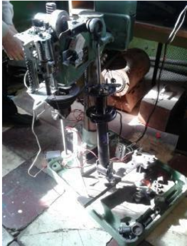
Рисунок 3.6 – Експериментальна установка самостійного виготовлення для дослідження амортизаторів по зусиллю стиску й відбою
