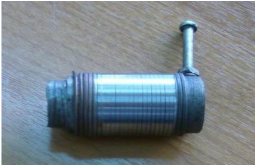
Рисунок 3.4 – Пружинний вкладиш на оправленні після круглого шліфування
