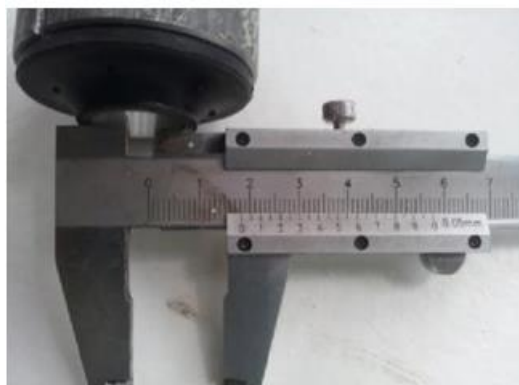
Рисунок 3.9 – Розточений внутрішній діаметр алюмінієвої втулки сайлентблока
