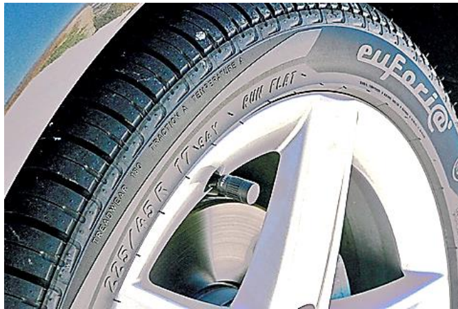
Рисунок 2. 5 Радіо ковпачок для передачі сигналу
