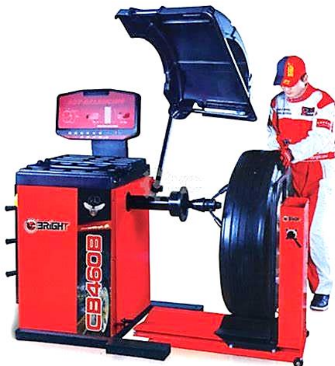
Рисунок 3.9 Балансування шини на універсальному верстаті BRIGHT CB460B (380 В)
