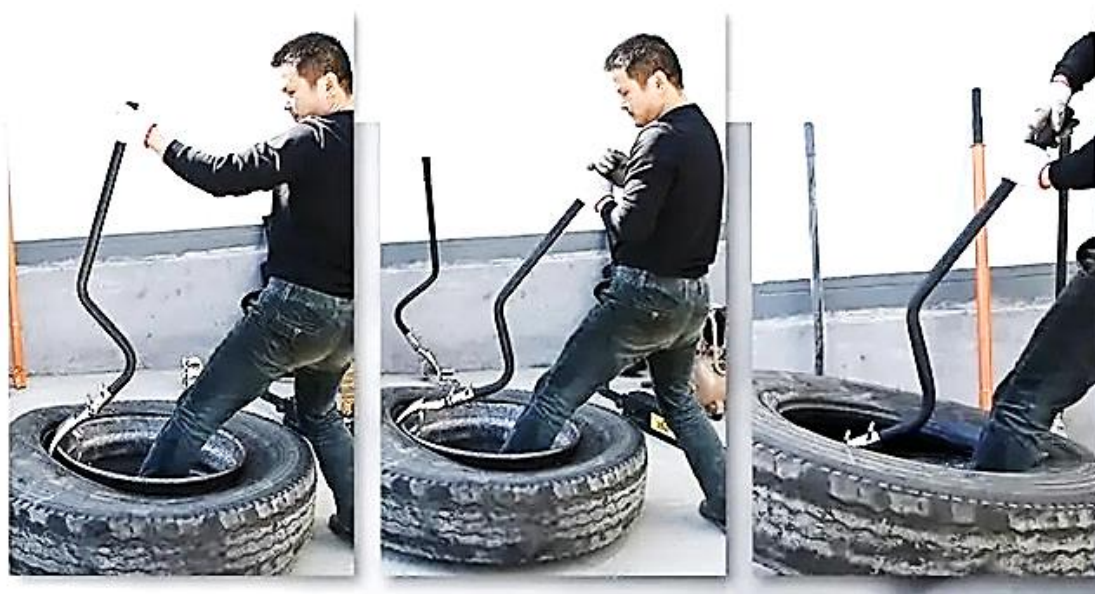
Рисунок 3.6 Почергове знімання шини з дика колеса
