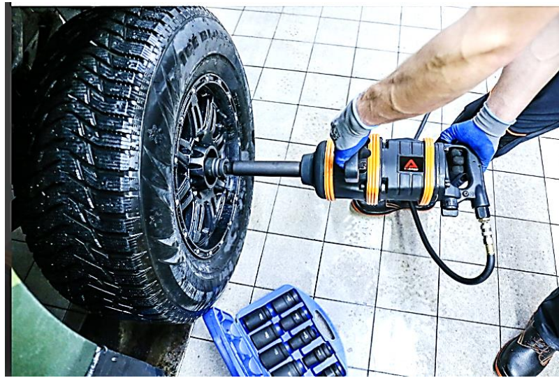
Рисунок 3.4 Відкручування гайок кріплення колеса пневматичним гайковертом
