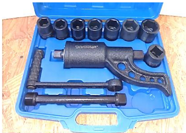
Рисунок 3.1 Ключ колісний редукторний НШД4 в комплекті з головками і важелями
