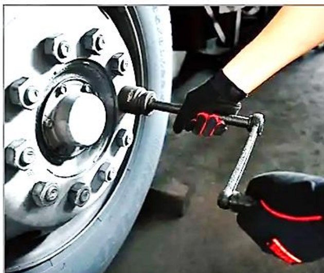
Рисунок 3.3 Використання подовжувача для швидкого відкручування гайок
