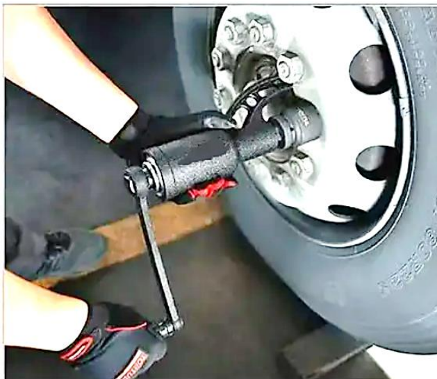
Рисунок 3.2 Використання для зрушування гайок ключа з планетарним редуктором
