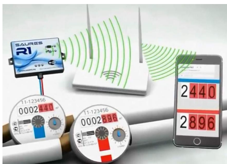
Рисунок 2.5 – Бездротові лічильники води, що використовують передачу даних за схемою лічильник - оператор стільникового зв'язку
