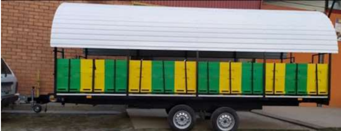
Рис. 1.2 - Причеп для перевезення бджолиних вуликів переобладнаний у критий павільйон
