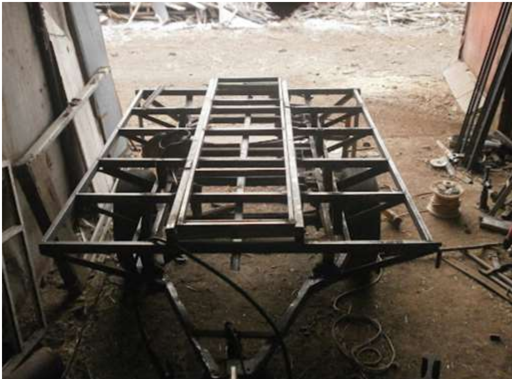
Рис. 1.7 – Платформа для перевезення бджіл виготовлена/вдосконалена в домашніх умовах
