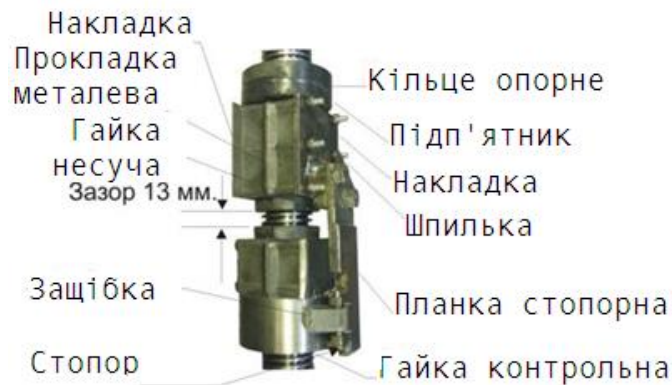
Рисунок 1.15 - Блок гайок гвинтового підйомника
