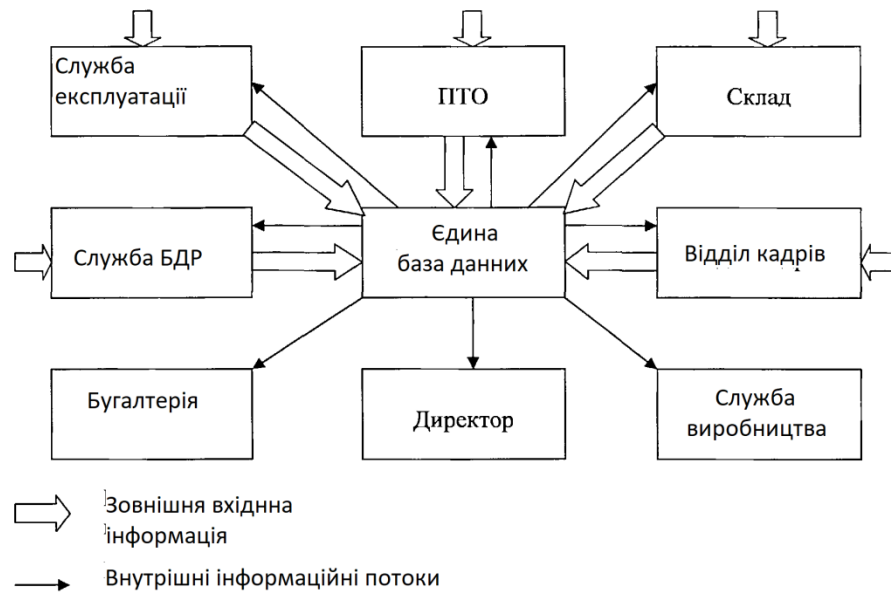
Рисунок 4.2 – Схема інформаційних потоків ПАТ при впровадженні методики визначення ресурсу автобусів
