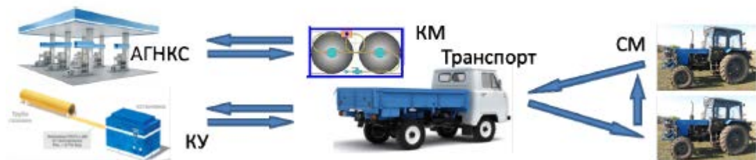
Рисунок 6.1 – Схема заправки сільськогосподарської техніки стисненим природним газом на основі знімних касетних модулів
