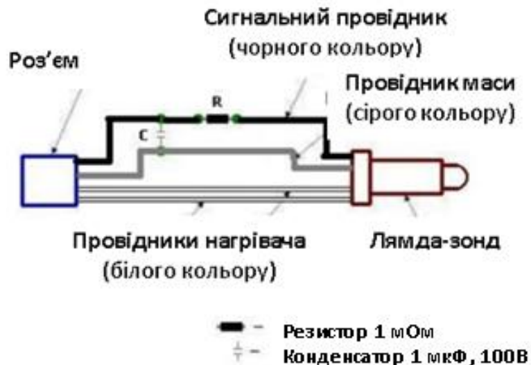
Рисунок 3.3 – Модернізована електромережа сенсора кисню.
