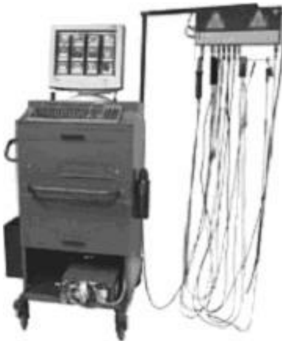
Рисунок 3.3 - Автодіагностичний стенд та мотортестер DasPas-65
