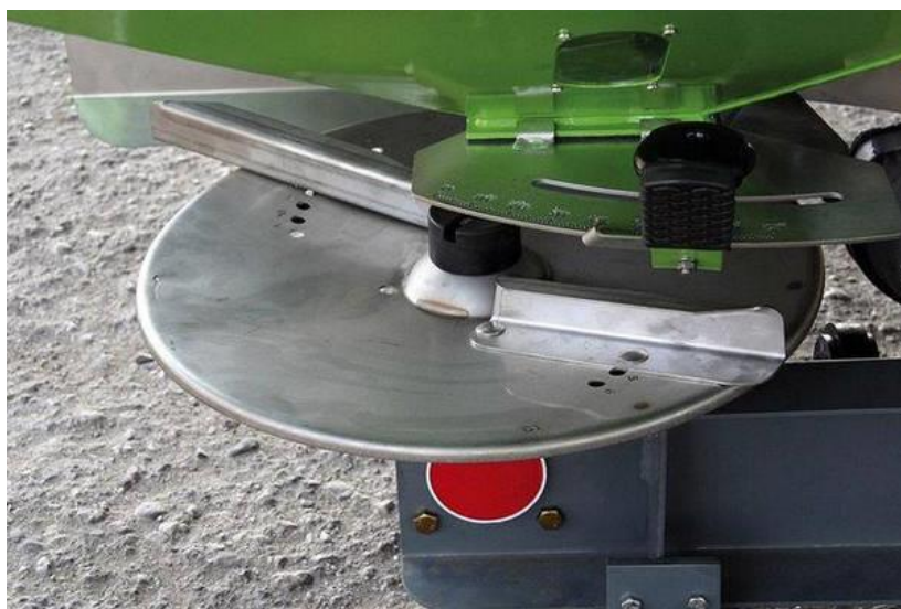
Рисунок 3.1 – Розкидний диск розкидача Unia MX 1600
