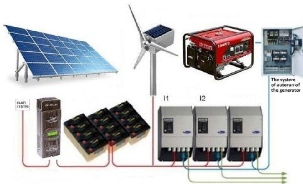
Рисунку 2.1 – Типова структурна схема автономних гібридних електростанцій
