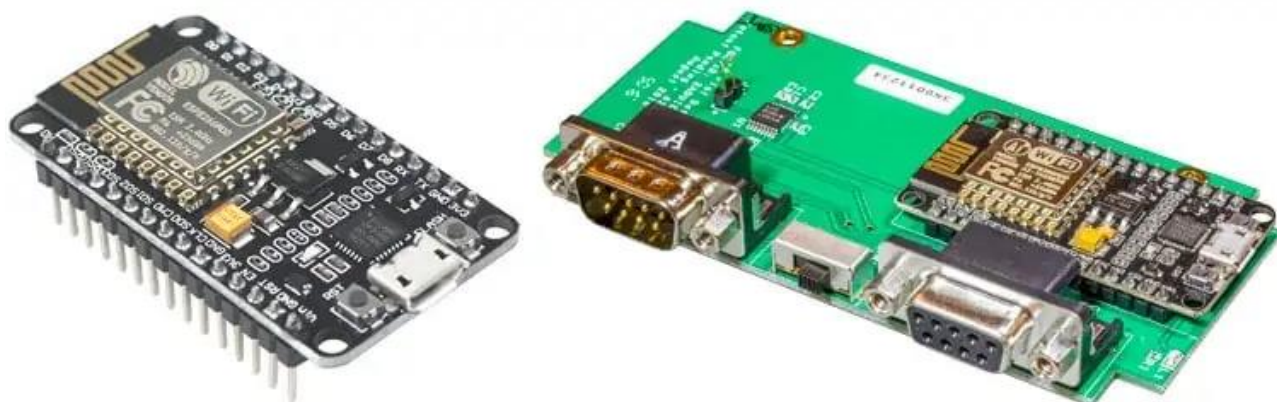
Рисунок 2.3 – Модуль NodeMCU на основі чіпа ESP8266 [41]
