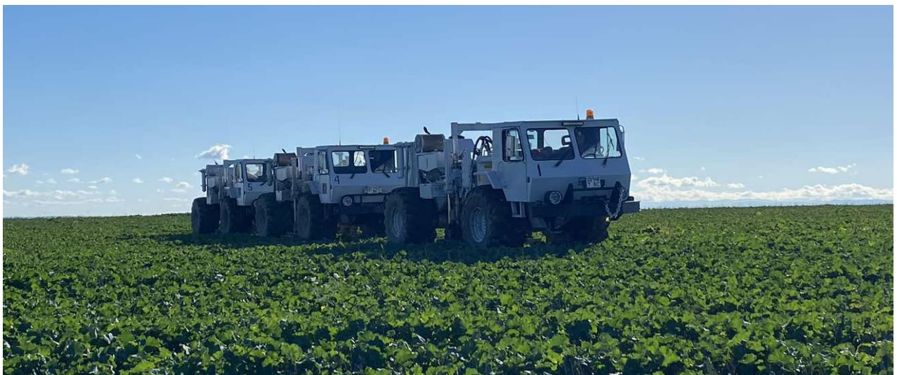
Рис. 4.1 Робота установки збудження сейсмосигналу (УЗСС) на профілі (НВД)
