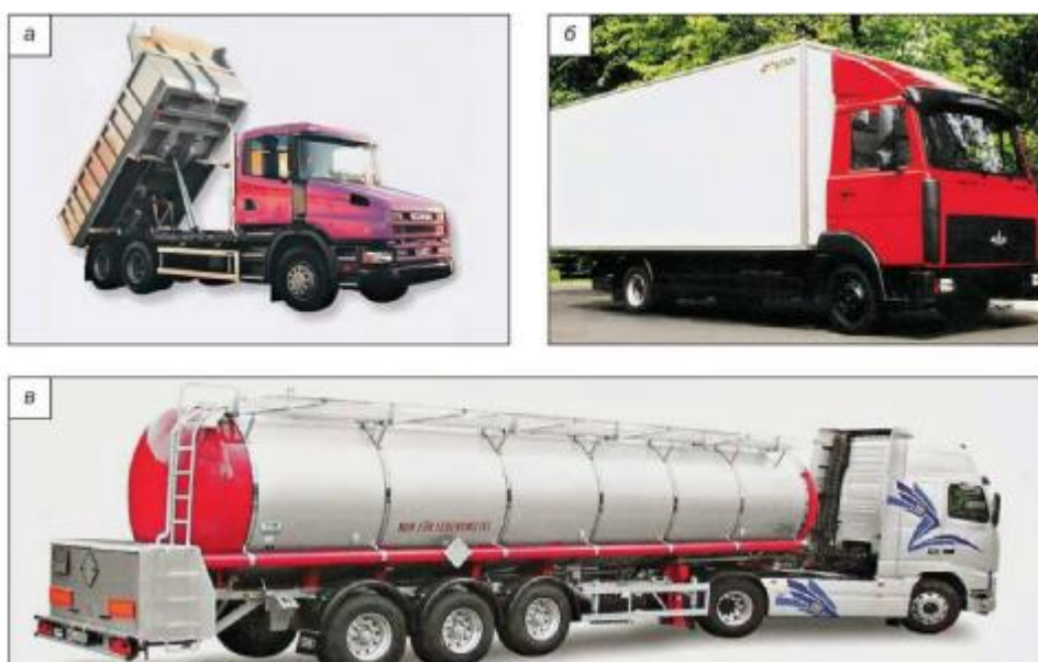
Рисунок 2.5 – Компонування ТЗ: а – самоскид, б – фургон, в – в складі сидельного тягача і напівпричепа
