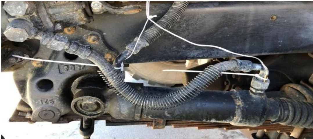
Рисунок 4.2 – Місця під'єднання термопар до трубопроводів силового циліндра
