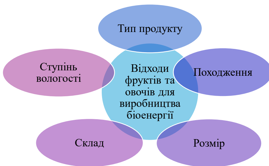
Рис. 1. Ознаки оцінення відходів фруктів та овочів для виробництва біоенергії
