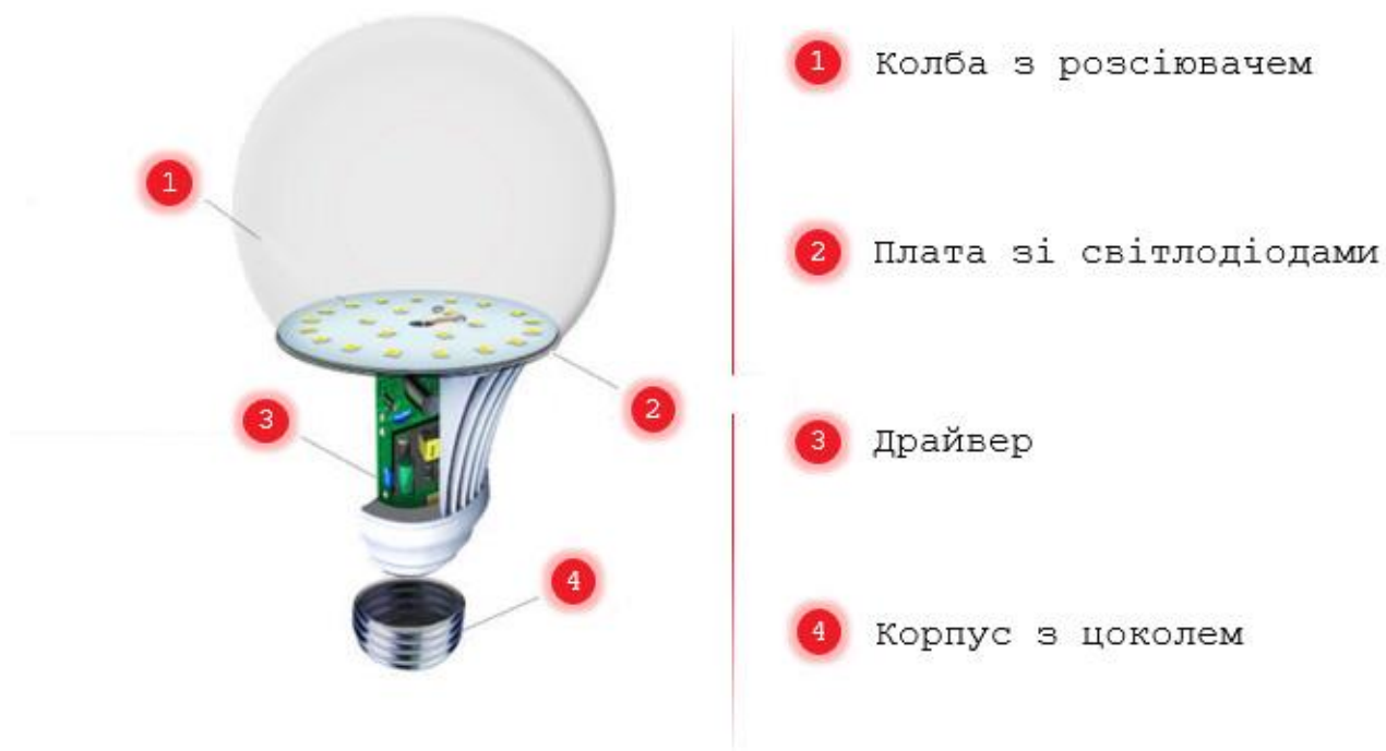
Рисунок 1.1 - Будова світлодіодних ламп
