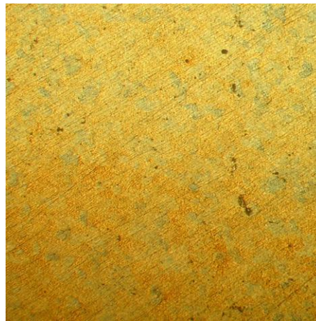
Рисунок 4.4 Мікроструктура сталі ШХ 15 в стані постачання зернистого перліту, \times 100
