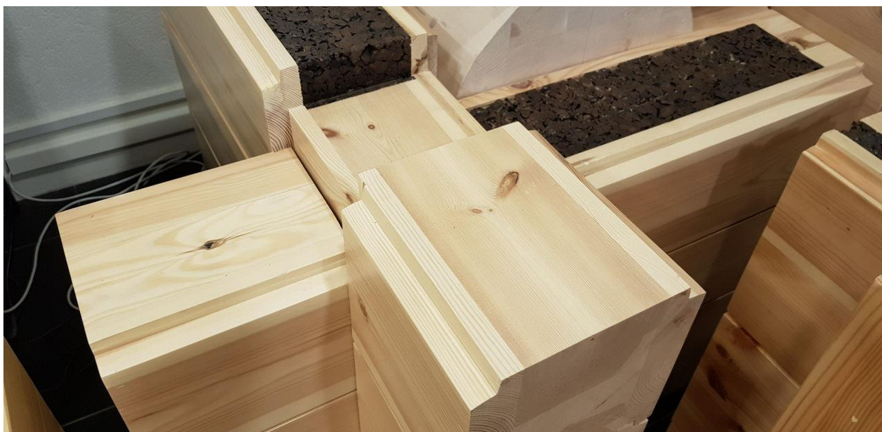
Рис. 6.10 Утеплений дерев'яний брус
