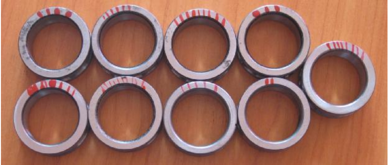
Рисунок 3.13 – Взірці внутрішніх кілець для дослідження граничного натягу
