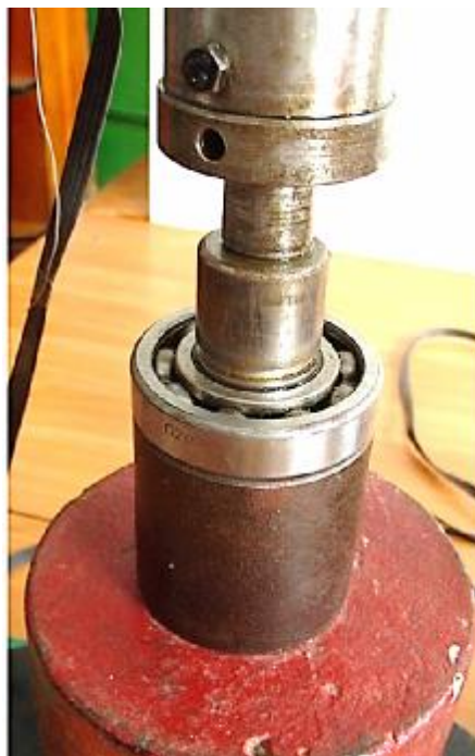
Рисунок 3.19 – Демонтаж підшипника з вала (фото)
