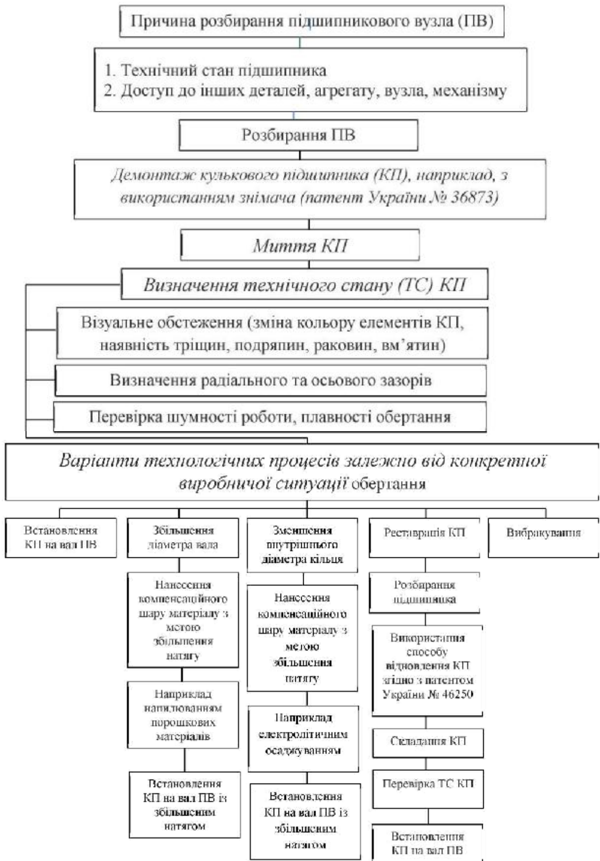
Рисунок 4.26 – Технологічна схема варіантів відновлення та/або збільшення ресурсу підшипникових вузлів
