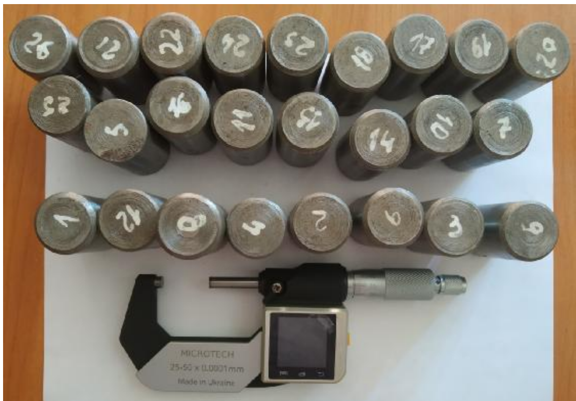
Рисунок 3.10 – Взірці валів для проведення дослідження зусилля монтажу та демонтажу та інструмент для визначення їхніх розмірів (фото)
