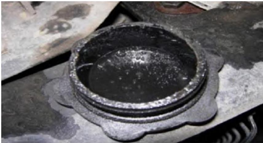
Рисунок 4.6. Конденсат на кришці оливо заливної горловини
