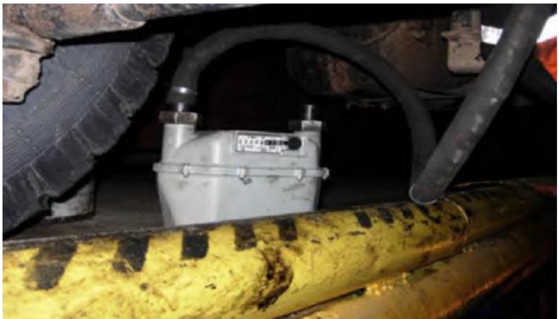
Рисунок 4.2. Вимірювання витрати картерних газів приладом ЛГМН-1
