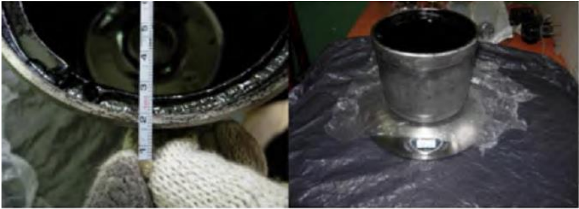
Рисунок 4.8. Визначення товщини відкладень і зважування ротора центрифуги
