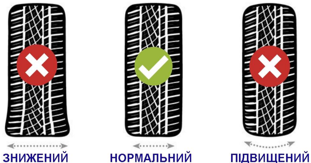
Рисунок 1.7. Пляма контакту шини з поверхнею в залежності від тиску в ній.
