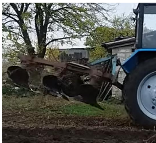
Рисунок 3.1 – Встановлення випробуваних лемешів на плугах типу ПЛН-3-35.
