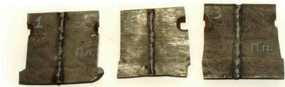
Рисунок 4.4 - Елементи лемеша з наплавленими валиками
