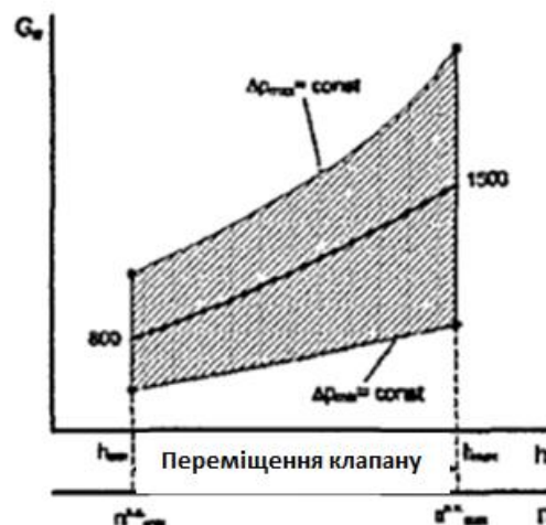
Рисунок 1.3 – Еп'юра спільної роботи бензинового двигуна із системою ХХ (заштриховане поле – кількість повітря, що проходить через байпасний простір регулятора холостого ходу).
