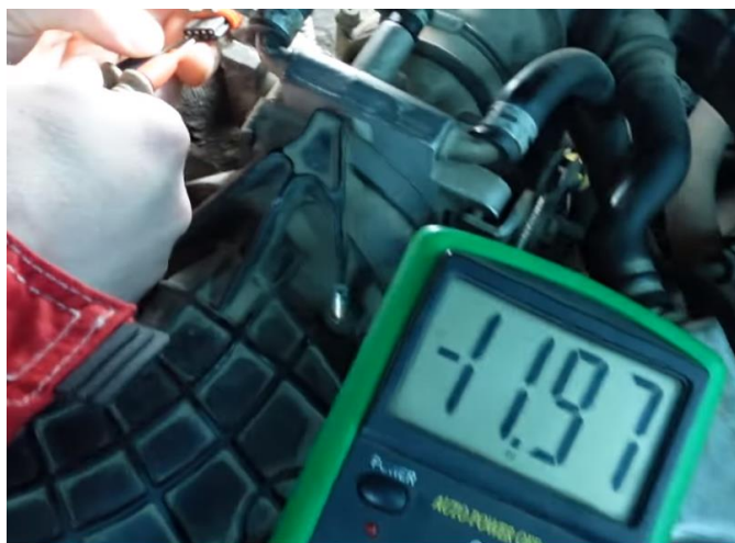
Рисунок 3.3 – Перевірка електричного живлення регулятора холостого ходу зі сторони ЕБУ
