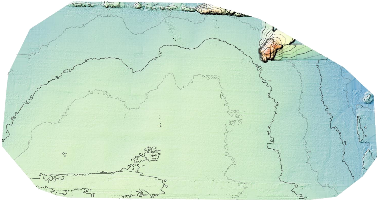
Рис.3.6. Створена модель поверхні рельєфу поля з горизонталями, проведеними через 0,25м
