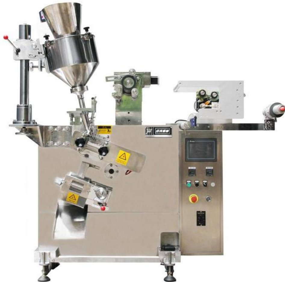
Рисунок 1.6 – Автоматична фасувально-пакувальна машина шнекового типу
