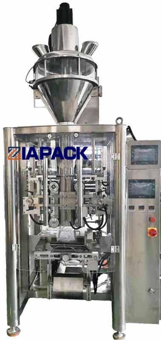
Рисунок 1.7 – Вертикальна автоматична фасувально-пакувальна машина
