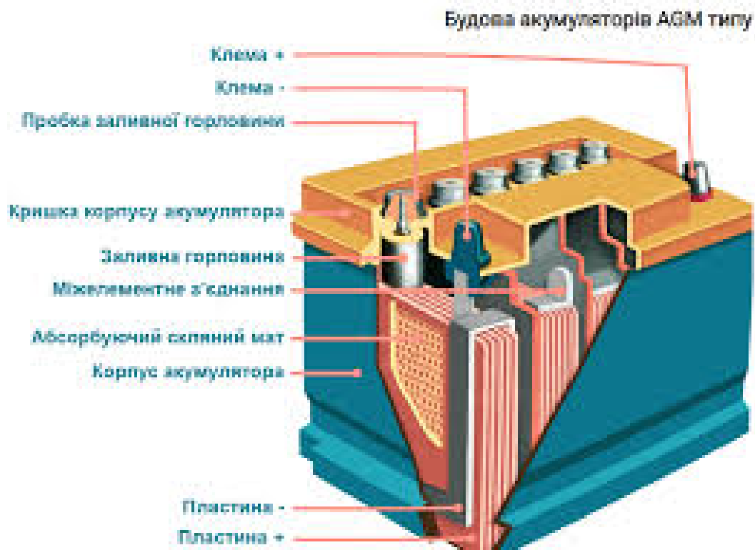
Рисунок 2.2 – Будова акумуляторної батареї
