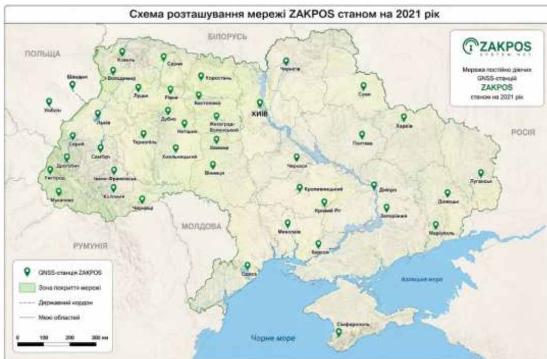
Рис. 1.6 Схема розташування мережі UA-EUPOS/ZAKPOS (2021 р.)
