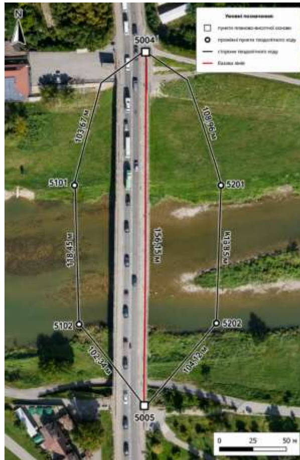
Рис. 2.5 Схема теодолітного ходу, прокладеного між пунктами планово-висотної основи
