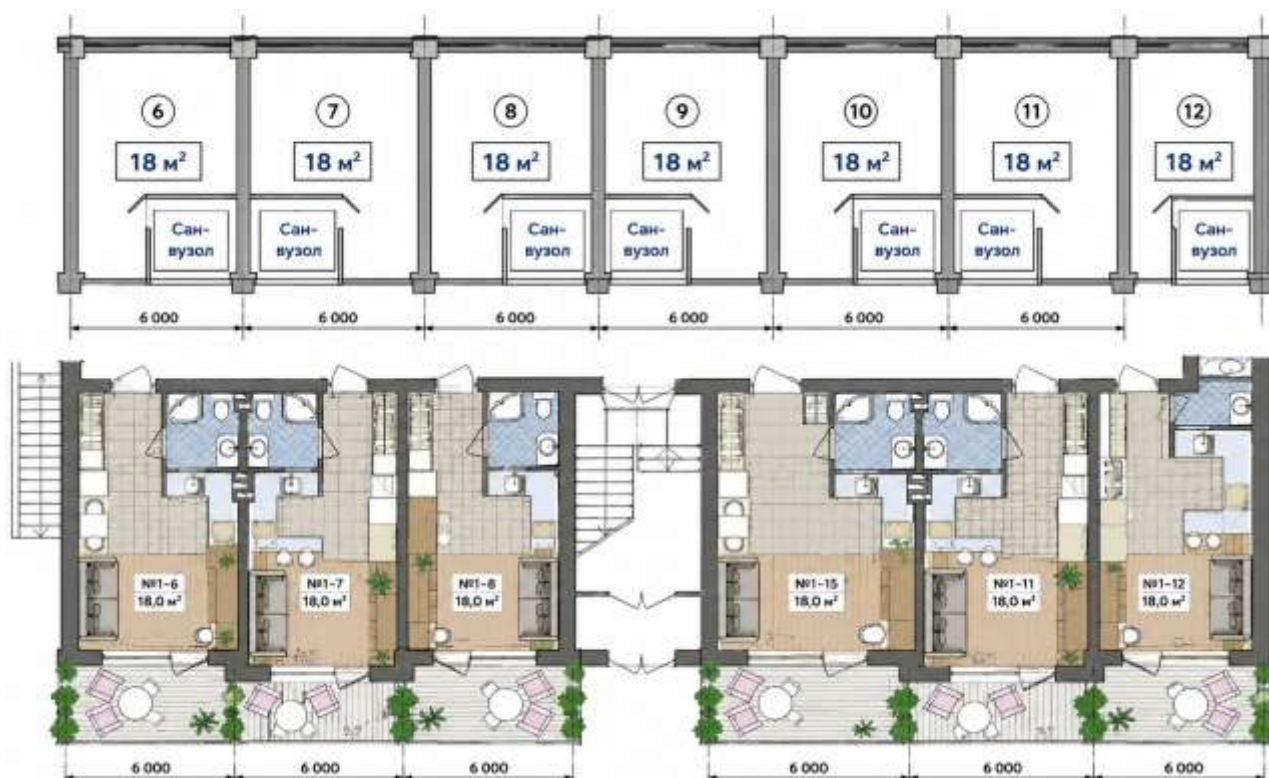
Рис. 3.3 Типовий півповерх перепланованої промислової будівлі
