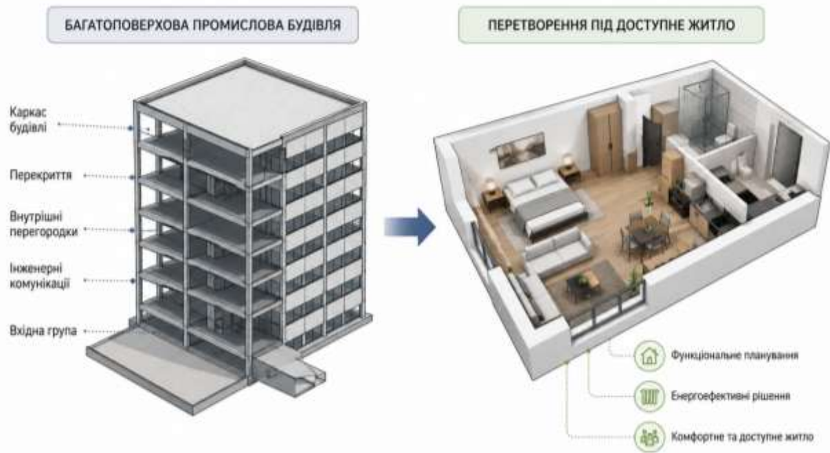
Рис. 3.1 Схематизація перетворення багатоповерхових промислових будівель під доступне житло
