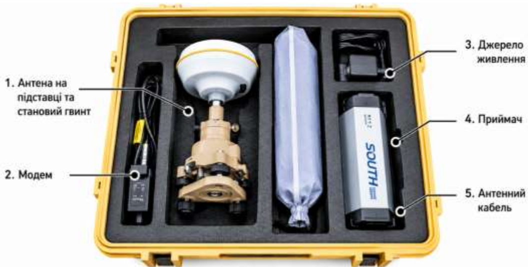
Рис. 1.2. Скомплектована мобільна базова станція
