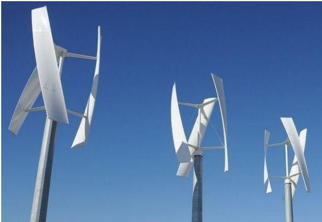
Рисунок 1.2 - Приклад вертикально-осьової вітроенергетичної установки (HAWT)
