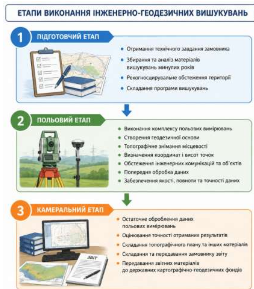
Рис. 2.1 Етапи виконання інженерно-геодезичних вишукувань
