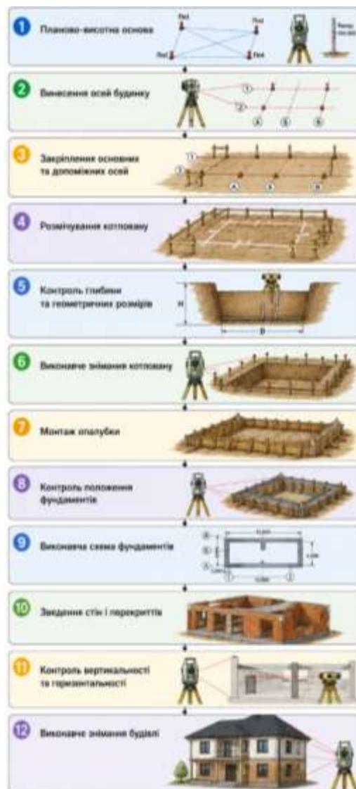
Рис. 3.7 Схема геодезичних робіт під час будівництва житлових будинків
