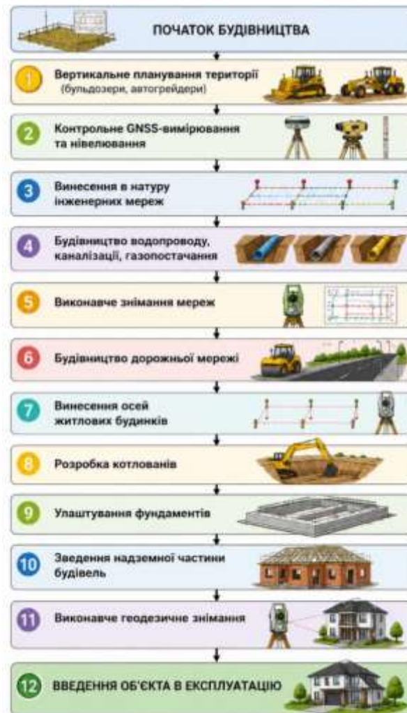
Рис. 3.5 Схема геодезичного супроводу будівництва
