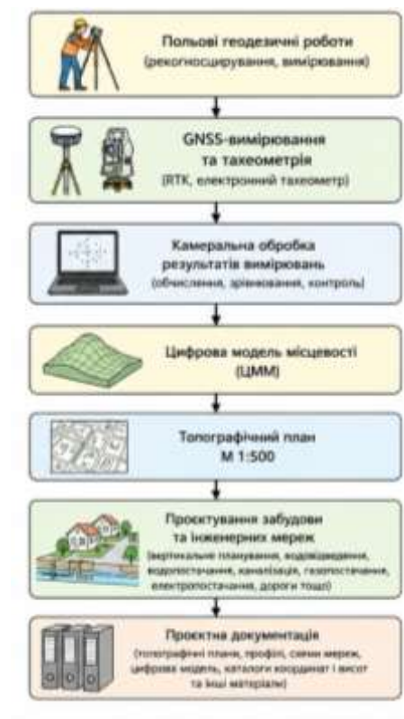
Рис 3.4 Узагальнена схема геодезичного забезпечення проектування
