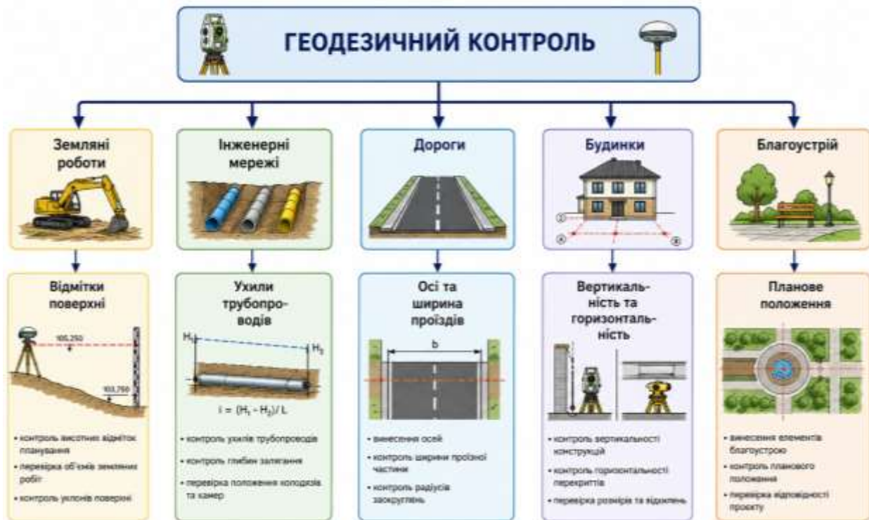
Рис 3.8 Основні напрями геодезичного контролю під час будівництва
