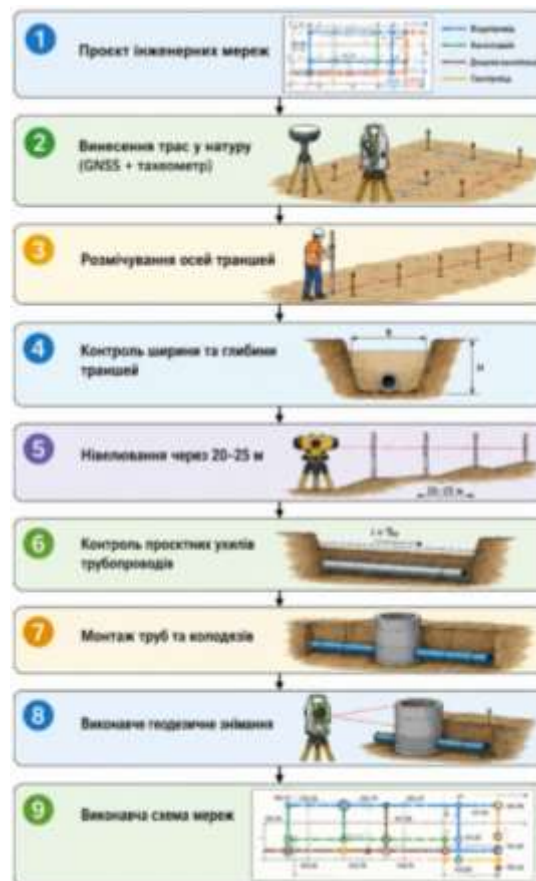
Рис 3.6 Геодезичний контроль будівництва інженерних мереж
