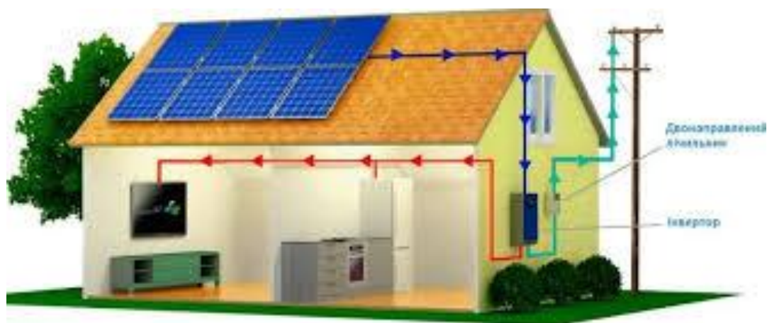
Рисунок 2.1 – Встановлення сонячної електростанції
