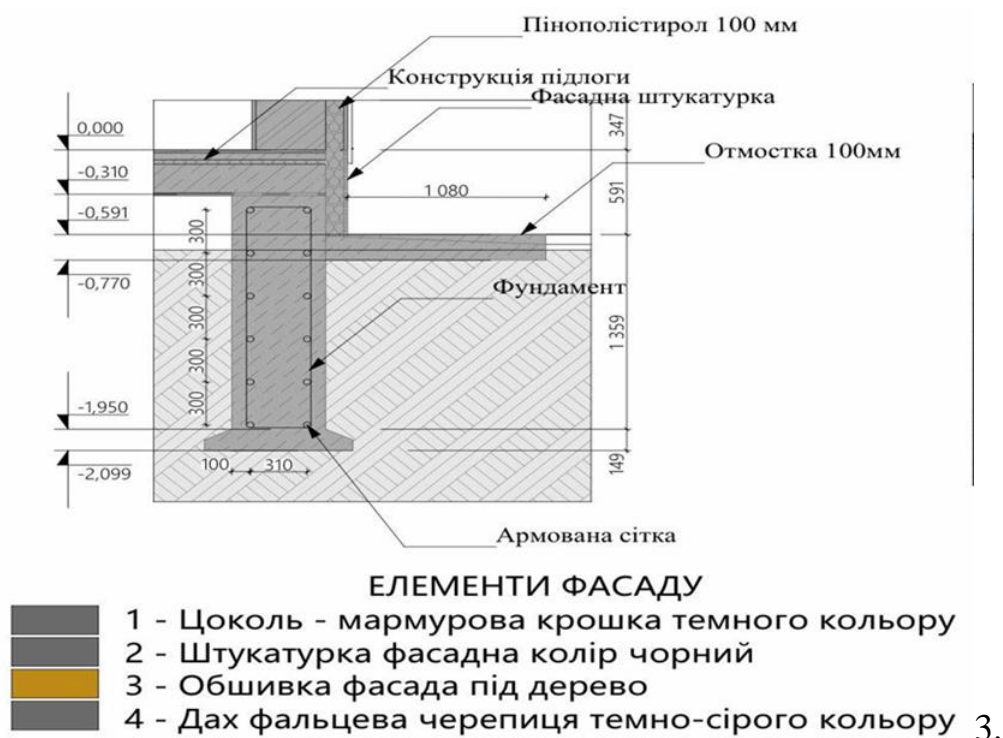
Рис 3.17. Конструкція фундаменту
