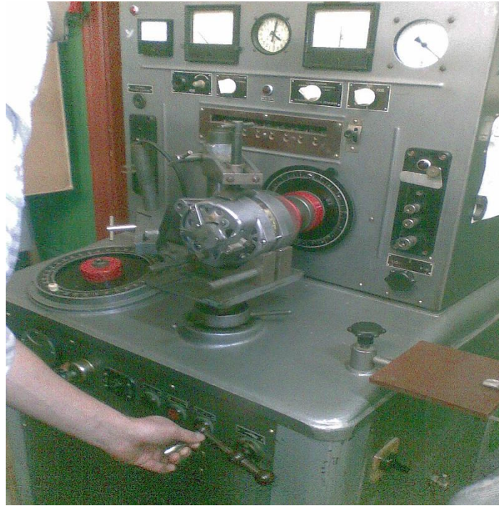
Рисунок 2.3 – Перевірка генератора на холостому ході (встановлення номінальної частоти обертання)
