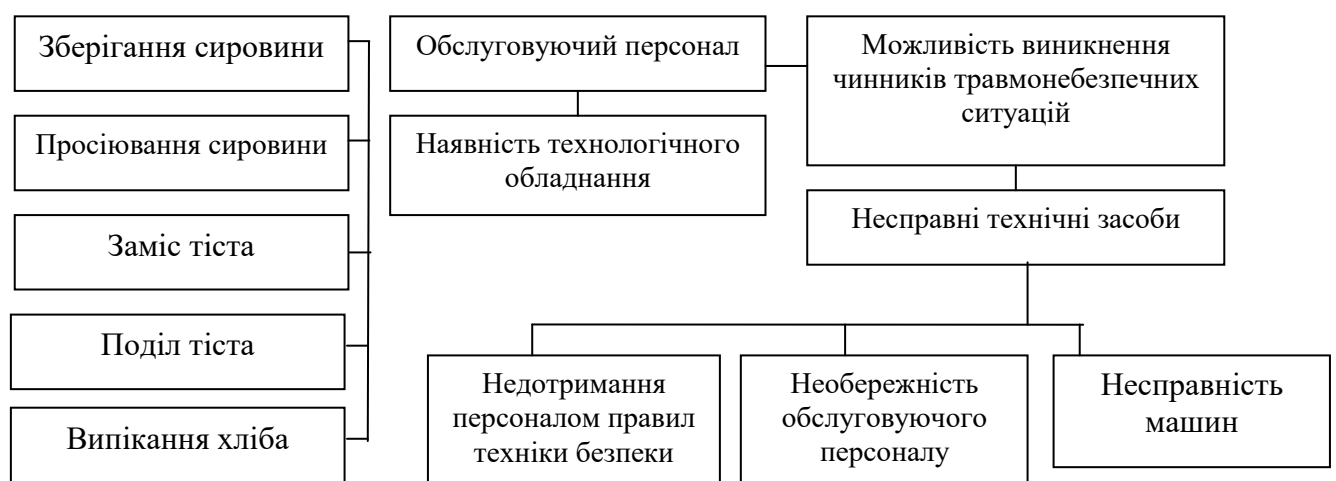
Рисунок 3.1 - Структурно-функціональна схема процесу виробництва хлібобулочних виробів
