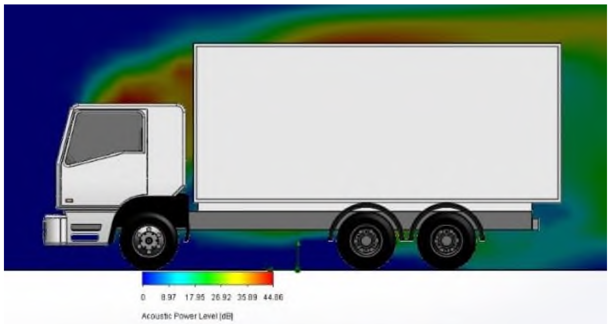
Рисунок 4.1 - Діаграма акустичного шуму без спойлера обтічника
