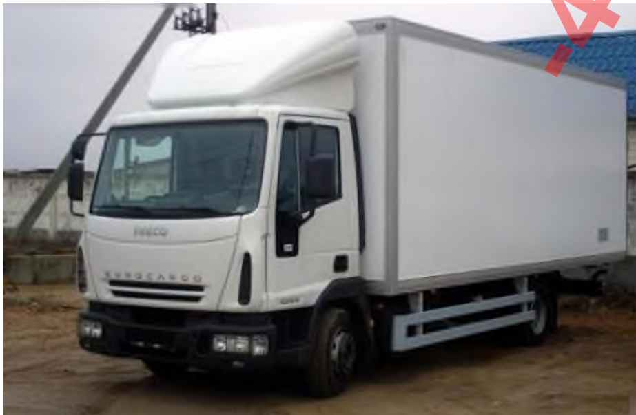
Рисунок 1.5 - Вантажівка зі спойлером-обтічником об'ємної форми.
