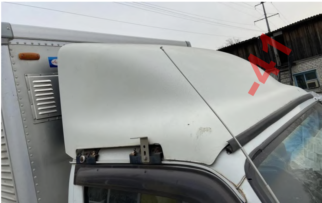
Рисунок 3.28 - Встановлений спойлер на кабіні вантажного автомобіля за допомогою болтових з'єднань.
