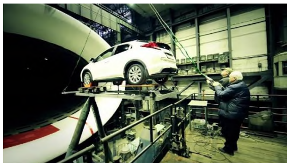
Рисунок 1.7 – Дослідження руху транспортного засобу в аеродинамічній трубі.
